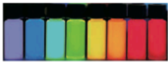
図5 サイズの異なる CdTe 量子ドットの発光色 (PlasmaChem社 Antipoff 氏提供; 10章参照)
